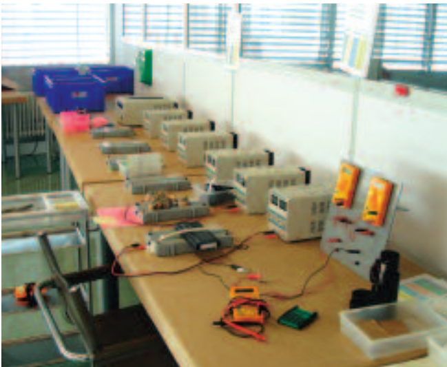
Jeder Akku, jedes Akkupack durchläuft eine Eingangskontrolle mit Lasttest. Hier die Abteilung für Eingangstests NiMH, NiCd und Li-Ion. Mechanisch defekte Zellen werden erkannt und ausgetauscht. Sodann gelangen die Akkupacks in den automatischen Ablaufprozess der Regeneration.
