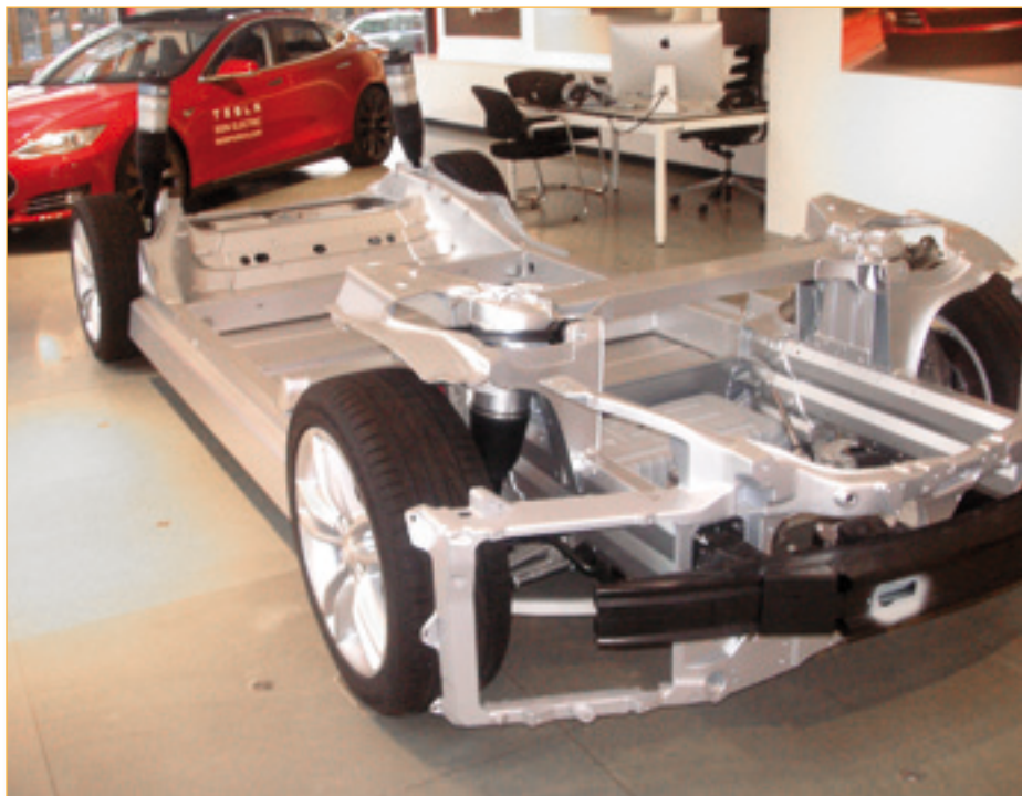
Tesla-S-Chassis: Das innovative Elektromobil mit 416 PS (310 kW) aus den USA besitzt hinten links den Elektromotor, daneben den Converter und vorne weitere Systeme für das Licht usw. Der Aufbau des Wagens hat im Vergleich zu Benzinern auffallend wenig Einzelteile, ist aber trotzdem sehr leistungsfähig. Reichweite: rund 480 km. Sieht so die Zukunft aus?
